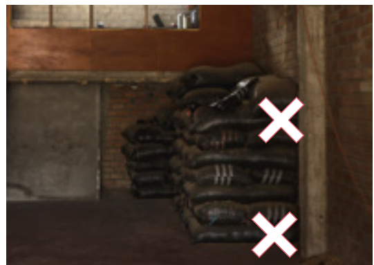
Figura 9: Almacenamiento inadecuado sacos de café pegados a la pared y sin tarima
