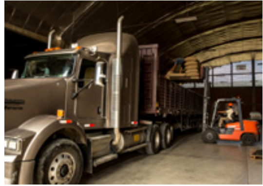
Figura 22: Usar una antecámara para la carga de café
